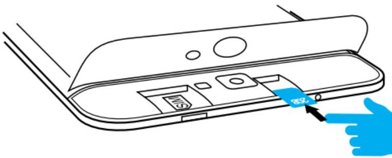
3. Inserte la tarjeta SIM en la posición indicada
